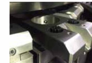
下模座搭配可替換式刷毛，以減少鋸件刮傷之可能。
